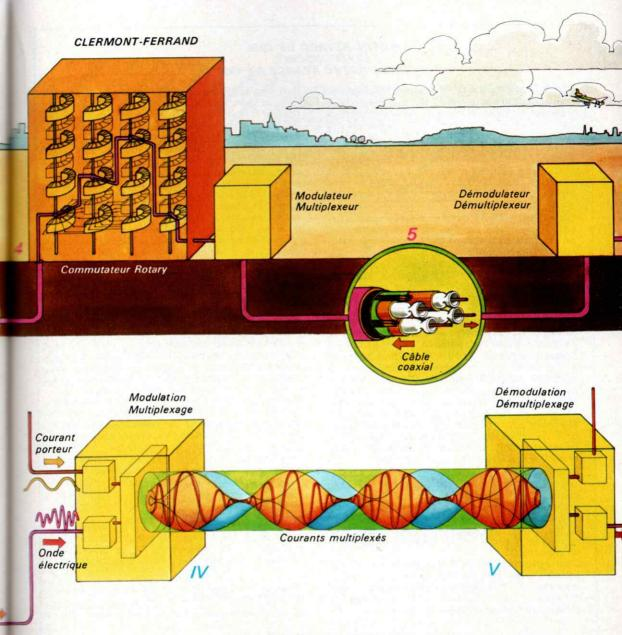
va composer le numéro du correspondant de New York. La série d'impulsions électriques engendrées par le cadran de l'opératrice se propagent le long d'un fil d'un « câble à paires » (3) (ainsi appelé car il est constitué d'une paire de fils, l'un transporte la voix du demandeur, l'autre celle de son interlocuteur), avant de parvenir à un commutateur « Rotary » (4), l'ancêtre ou presque des commutateurs. Son rôle : aiguiller l'appel vers son destinataire. Le Rotary qui
