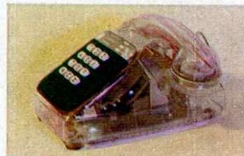
Ce modèle engendre à la fois des impulsions et des fréquences et peut donc se relier aussi bien à un commutateur électro-mécanique qu'électronique. Le circuit compatible comprend sous l'organe de trappe (touches) le circuit pour impulsions et le circuit générateur de fréquences. Le grand avantage de ce poste, qui n'existe qu'en France, est de pouvoir appeler un ordinateur et de dialoguer avec lui par l'intermédiaire du réseau national.
