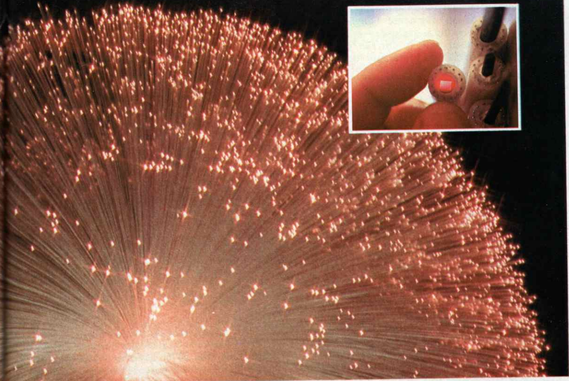
Pour cette boule lumineuse, hérisson de fibres de verre servant de bibelot décoratif, et pour ce câble de 144 fibres optiques capable de transmettre 50 000 conversations téléphoniques simultanées, un même principe : des rayons lumineux « piégés » et canalisés dans un guide transparent.
