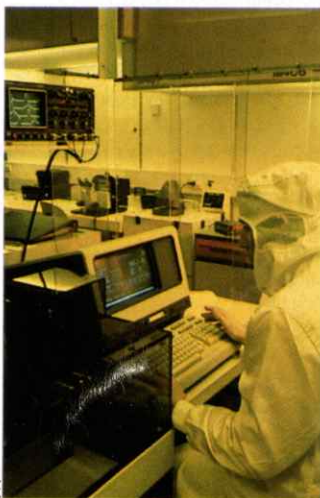
Les motifs de chaque couche du circuit sont réalisés par photolithographie. La photo (D) montre le couchage de la résine photosensible. Un photorépéteur (E) permet d'insoler la résine par les rayons UV à travers un masque. Les parties non protégées par la résine sont attaquées par gravure au plasma (bleu). Un laser (rouge) mesure l'épaisseur de la couleur (F).
